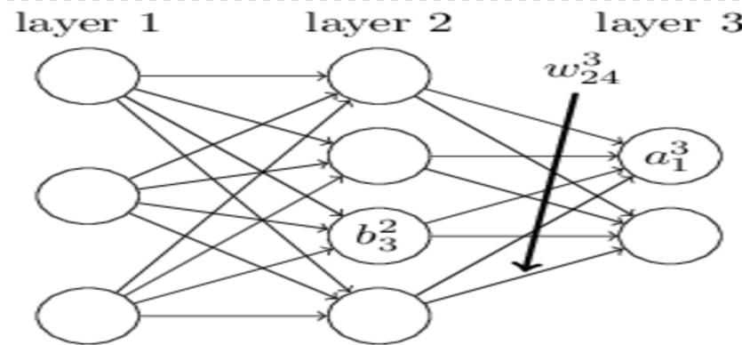
这是一个包含三个层次的神经网络。**layer 1**的是输入层，**layer 3**的是输出层，**layer 2**的是中间层（也叫隐藏层）。输入层有3个输入单元，隐藏层有4个单元，输出层有2个单元。
